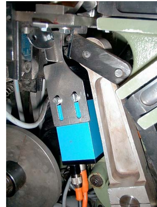
Bild 5: Einsatz des Intelligent Camera Sensors zur Detektion von Steuerbänderolen auf Zigarettenschachteln hinter Transparentfolien
